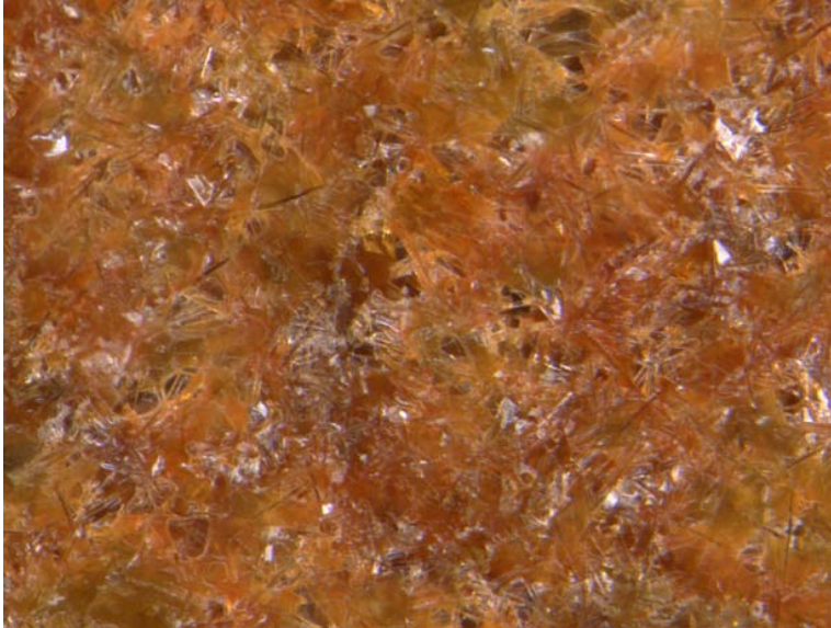
Kuva. Rosoinen kidelasitepinta. Kiteitä muodostuu useita päällekkäin, pinta ei ole sileä, eikä tasainen.
