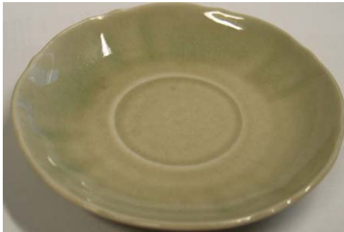
Kuva. Celadon lasite, maasälpälasite, jossa kvartsi on korvattu Hangan hiekkarannan hiekalla, josta läpikuultava lasite saa vihertävän värin. (Hortling, 1968)
