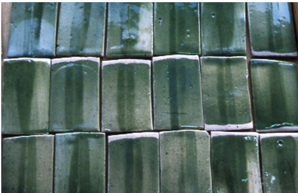
Kuva. Cr- \text{SiO}_2 , vihreä, polttoalue (1000-1300°C). Vihreä pigmentti on stabiili useiden eri lasitteiden alla testattuna.
