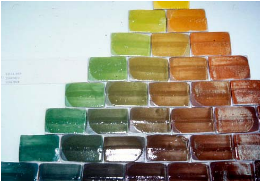
Kuva. Kolmella zirkoniumsilikaattipigmentillä on sekoitettu 66 eri värisävyä. Kuvassa on osa värikolmiosta, jossa ylin väri on Citrus, keltainen. Vasen puoli koostuu keltaisen ja turkoosin yhdisteistä. Oikea puoli koostuu Citrus keltaisen ja Coral Red pigmenteistä. Kolmion keskellä värisävyt koostuvat kaikista kolmesta pigmentistä.
