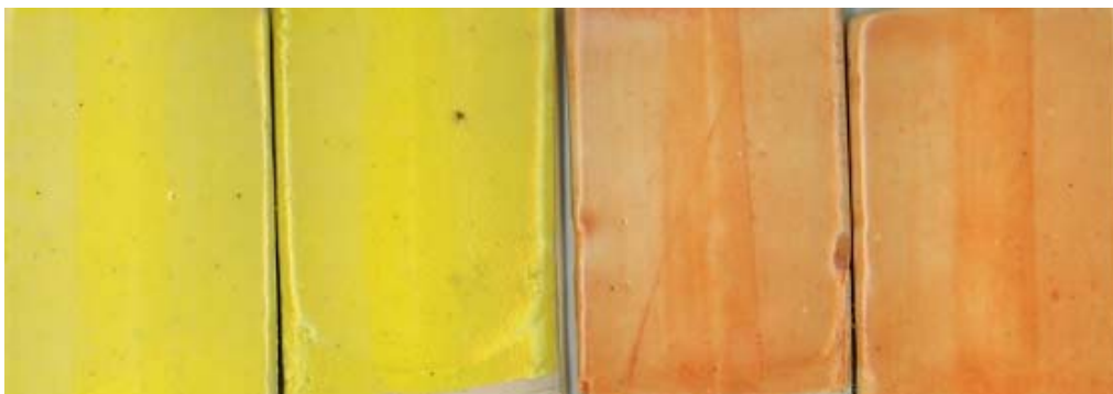
Kuva. Praseodyymin keltainen, Citrus, PrZrSi, 1300°C ja oranssi, Mandarin, CdSeSZrSiPr, 1300°C. ZrO 2 -pohjaiset keltaiset värit kestävät korkeita lämpötiloja.
